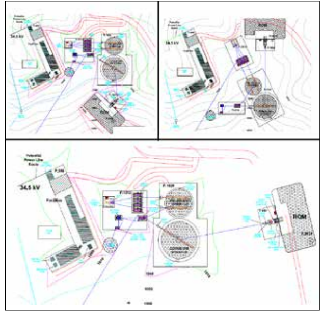
Şekil 6 – Kırma Tesisi Yerleşim Senaryoları
