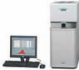
SC632 Rezistans Fırın Karbon Kükürt Analiz Cihazı
